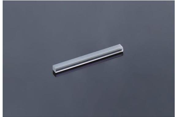
炬光科技新款蓝光快轴准直器 Blue FAC 300 的几何外形与现有红外光快轴准直器 FAC 300 接近，**设计紧凑**：长 4mm（可定制其他长度）、宽 0.5mm、厚 0.41mm。因此，Blue FAC 300 的对准与装配可**直接使用适配红外光快轴准直器**的设备进行。
